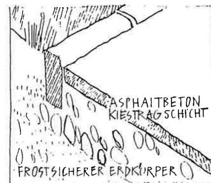
Für den Unterbau der Zufahrten, Höfe und Stellplätze soll anstelle von Kies / Schotter überwiegend Bauschuttgranulat aus dem Bauschuttrecycling eingesetzt werden.
