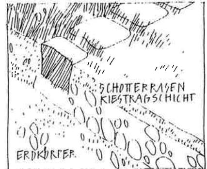
Durchlässige Beläge sind beispielsweise Schotterrasen, durch Gittersteine befestigter Rasen und offenfugiges Pflaster.
